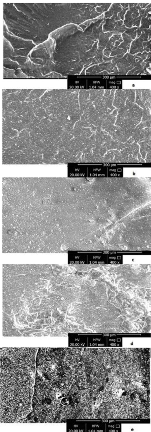
**Fig. 4.** SEM images of EPDM (a) 0wt% W, (b) 30wt% W, (c) 45wt% W, (d) 60wt% W and (e) 70wt% W.
