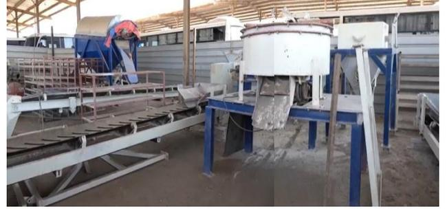
شكل رقم 39- مصنع كامل لإنتاج طوب التربة المضغوطة ملحق بمركز الأرض (24)
