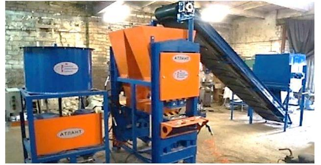
شكل رقم 13- ماكينة كبس هيدروليكية مميكنة بالكامل (9)
