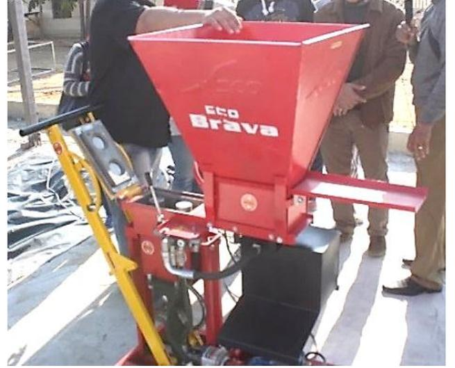
شكل رقم 12- ماكينة الكبس الهيدروليكية نصف أوتوماتيك (13)
