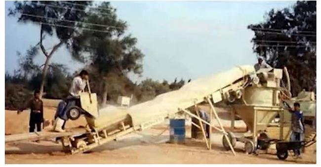
شكل رقم 11- مرحلة خلط المكونات و التجهيز للكبس (12)
